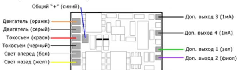
Схема подключения при отсутствии в модели платы с разъемом:
